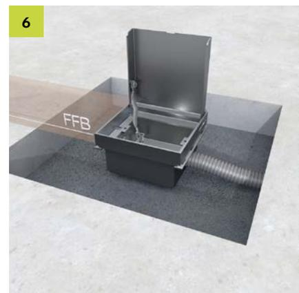
Die Bodensteckdose in den Hohlraum einsetzen. Es ist sicherzustellen, dass die Bodensteckdose auf Fertigfußbodenhöhe ausgerichtet ist.
