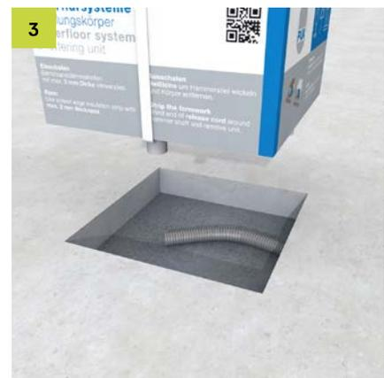
Nach Aushärten des Estrichs den Schalungskörper mit Hilfe der Reißbleine sorgsam entfernen.
