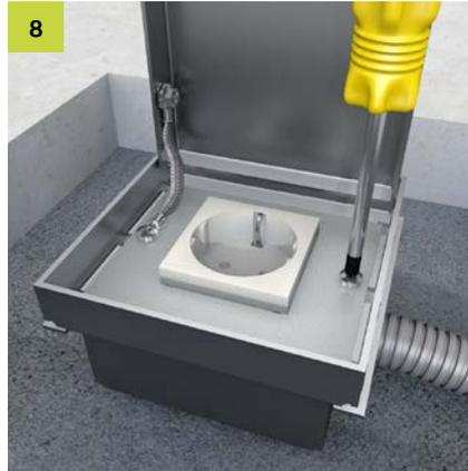
Nach dem Anschluss der Steckdose wird die Abdeckplatte über die Schrauben wieder am Rahmen der Bodensteckdose fixiert. Potentialausgleich beachten.
