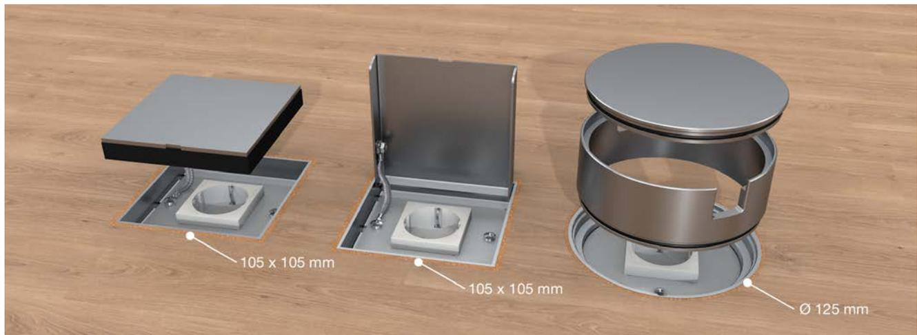
Eckige und runde Bodensteckdosen in den Abmessungen 105 x 105 mm und Ø 125 mm für trocken und nass gepflegte Räume zum direkten Einbau in den Estrich mit geringer Aufbauhöhe. Als Blindausführung (UBSK-VP WI E), mit Klappdeckel (UBSK-V WI E) oder als Tubus (UBST-R WI-WD).
