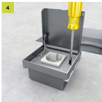
Die Abdeckplatte und die Erdungsleitung vom Rahmen der Bodensteckdose lösen.
